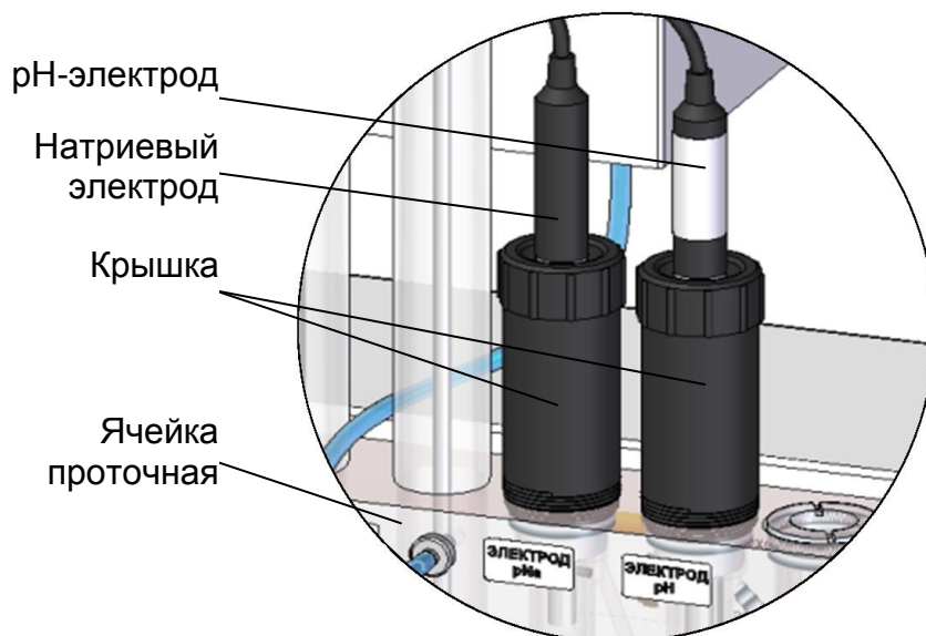
Рисунок 2.8 – Расположение натриевого и pH-электродов в ячейке проточной (местный вид)
