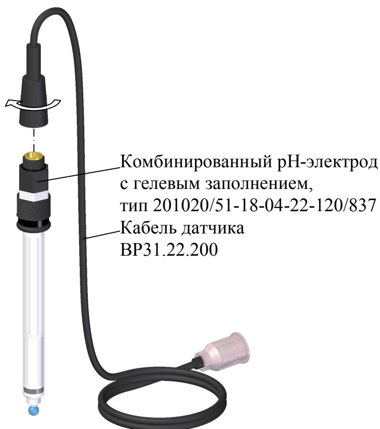
Рисунок 2.2 – Подсоединение кабеля датчика ВР31.22.200 к электроду
