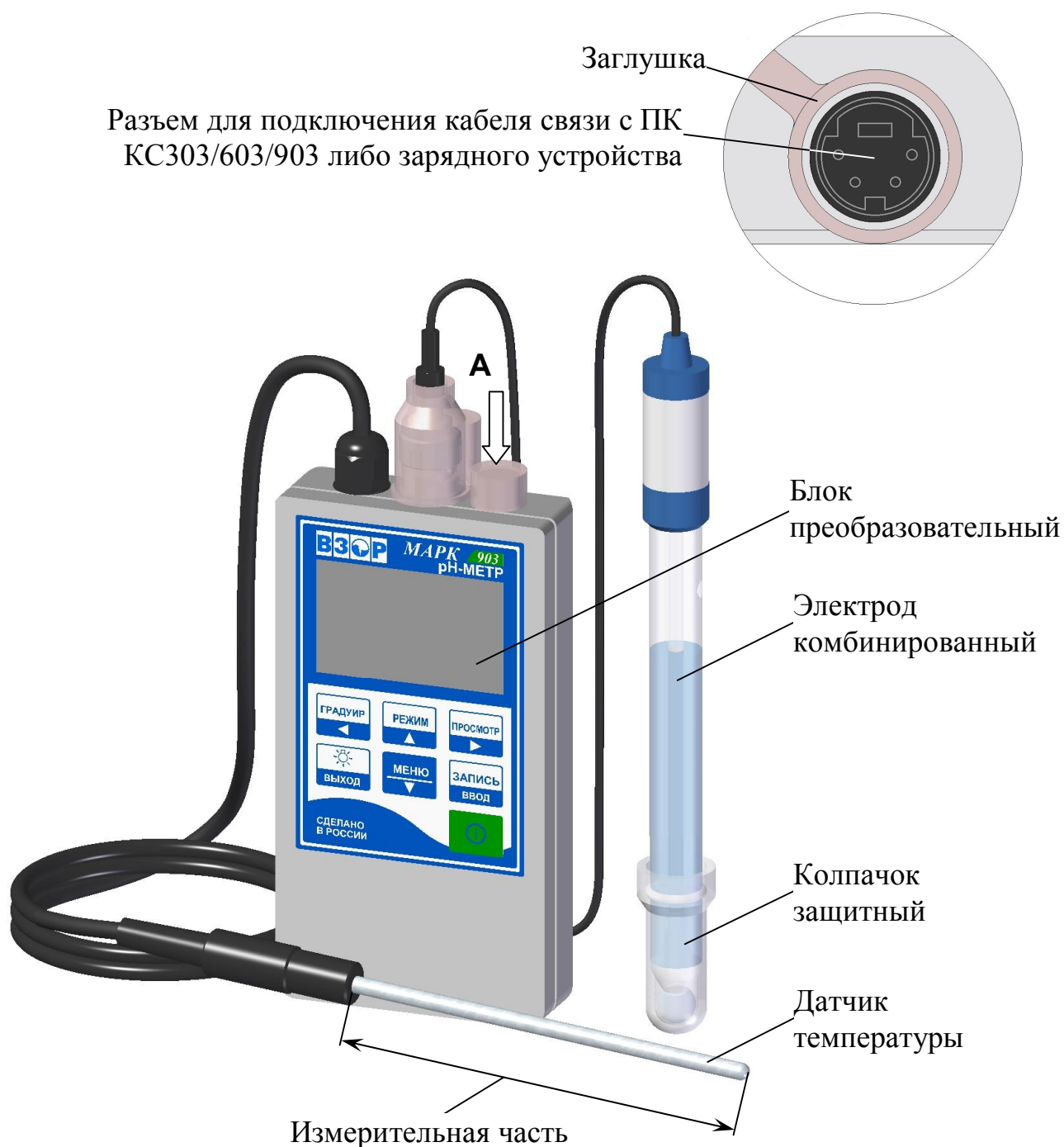
Рисунок 1.1 – pH-метр МАРК-903 (вид спереди)
