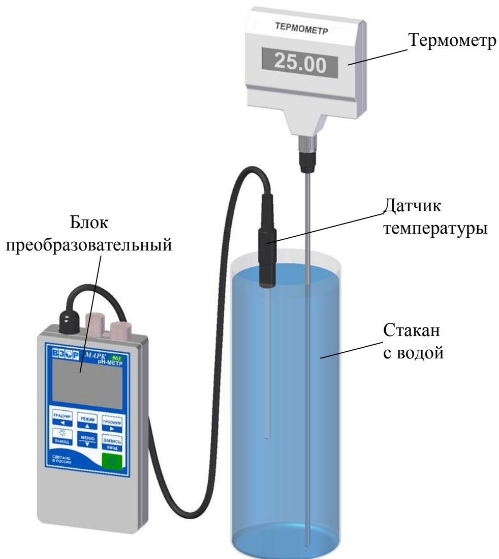
Рисунок 3.2 – Проверка показаний по температуре
