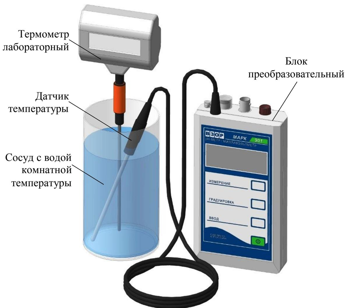
*Рисунок 3.2 – Проверка показаний по температуре*
