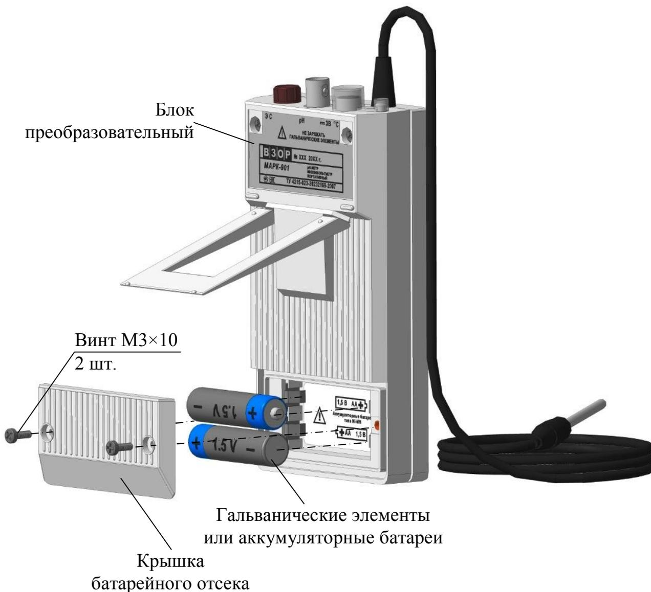
*Рисунок 2.1 – Установка гальванических элементов либо аккумуляторных батарей*
