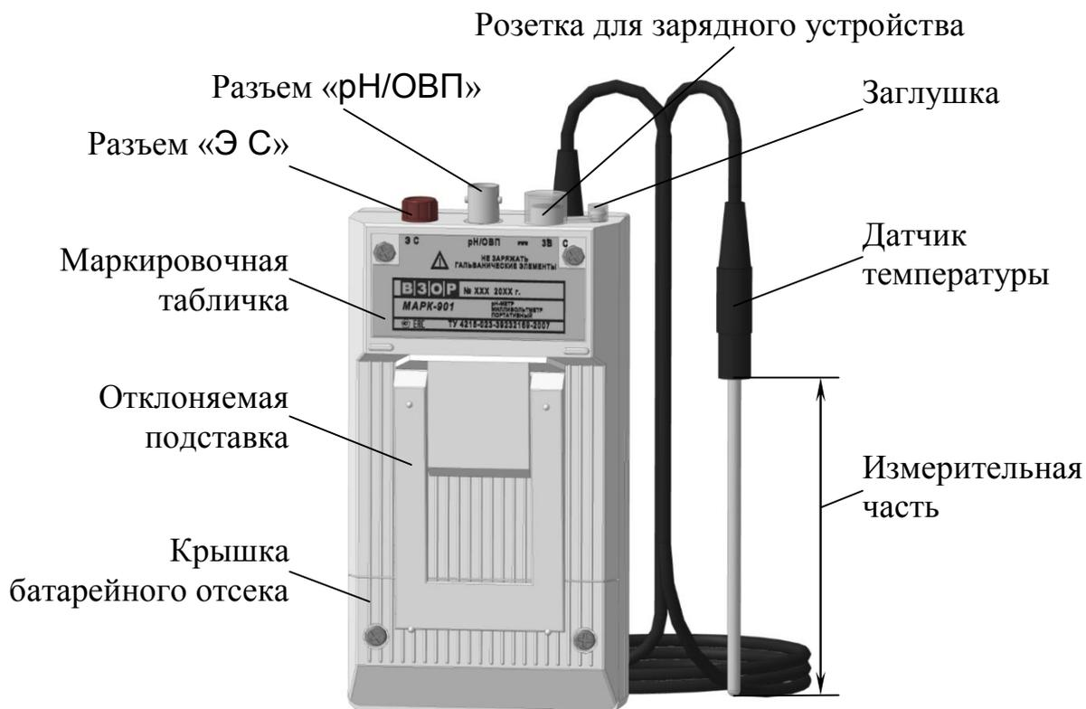
Рисунок 1.2 – Блок преобразовательный (вид сзади)
