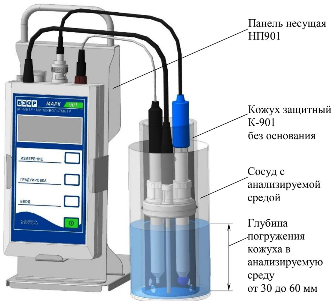
*Рисунок 2.12 – Проведение измерений с использованием кожуха защитного К-901*
