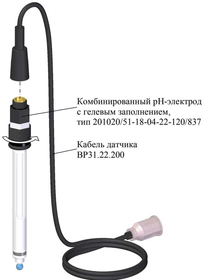
*Рисунок 2.3 – Подсоединение кабеля датчика к электроду*
