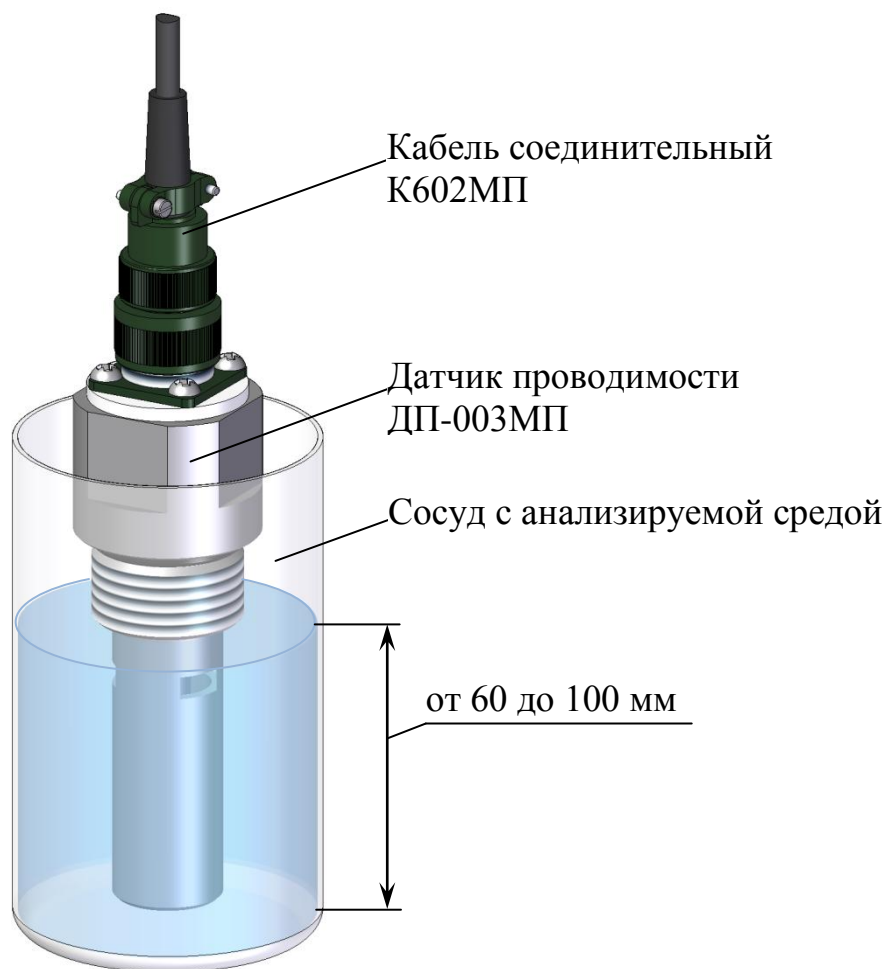
Рисунок 2.7 – Расположение датчика проводимости ДП-003МП в сосуде
