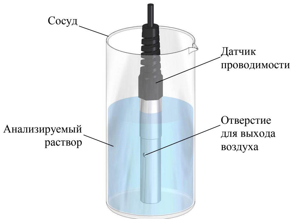
Рисунок 2.3 – Проведение измерений погружным методом
