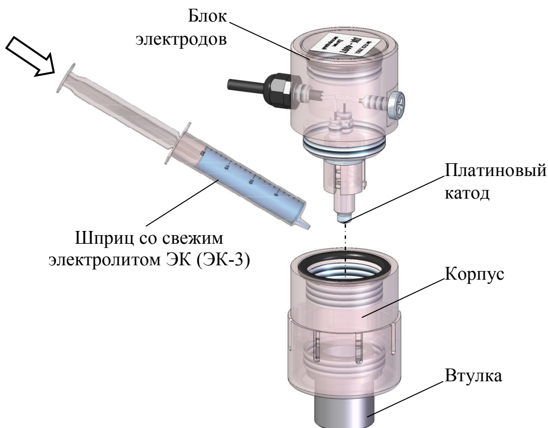
Рисунок 2.6 – Заливка электролита в датчик ДК-409Т, ДК-409ТМ
