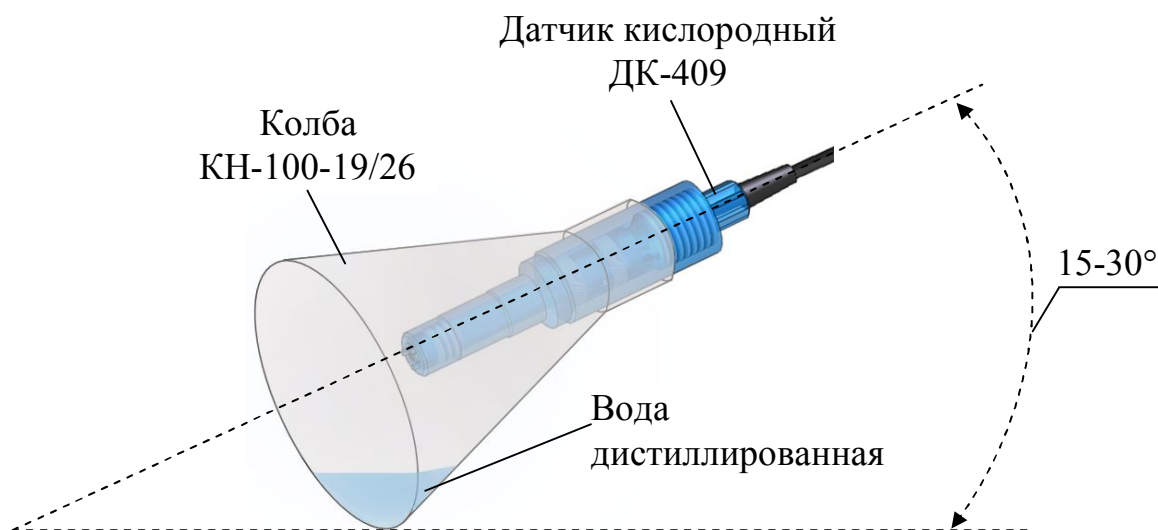
Рисунок 2.7 – Градуировка датчика ДК-409
