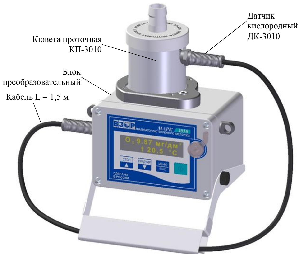
Рисунок 1.1 – Анализатор растворенного кислорода МАРК-3010
