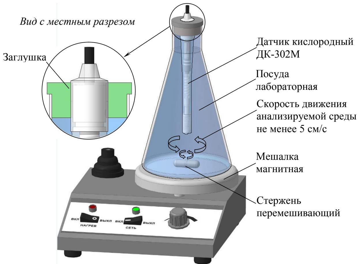
Рисунок 2.30 – Положение датчика в лабораторной посуде при измерении КРК (УНК)
