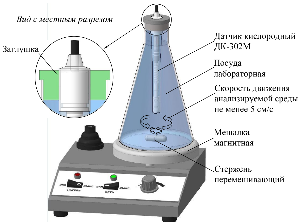
Рисунок 2.7 – Положение датчика в лабораторной посуде при измерении КРК (УНК)
