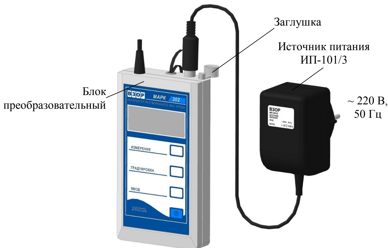
Рисунок 3.2 – Зарядка аккумуляторных батарей
