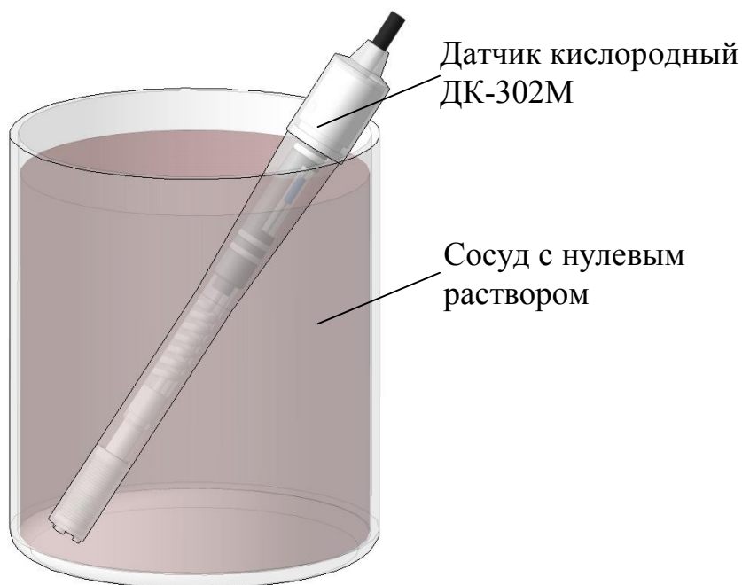
Рисунок 2.3 – Проверка показаний в «нулевом» растворе
